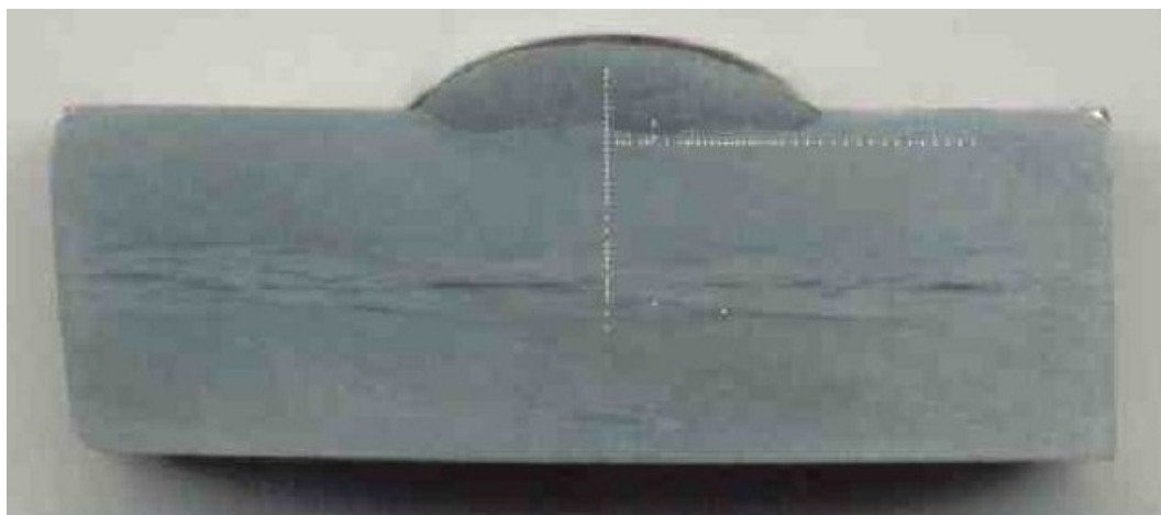
FIGURA 12 - Macrografia indicando as impressões do teste de microdureza da amostra 4BIII.
