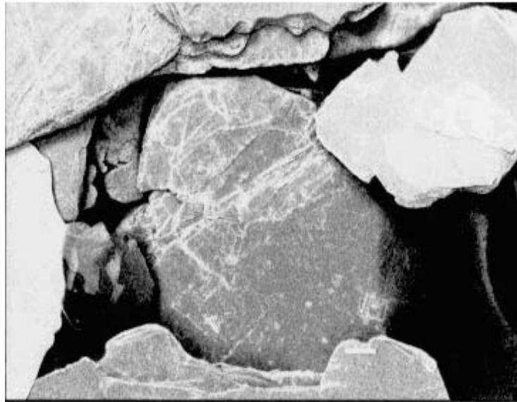
Figura 4.5 – Micrografia mostrando a morfologia e textura de uma amostra de vermiculita, utilizada nos ensaios de adsorção.
