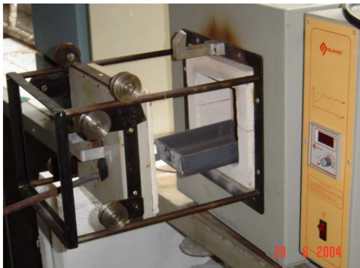
Figura 3.1 – Fotografia, mostrando detalhes de adaptação da mufla realizada no dispositivo de abertura.
