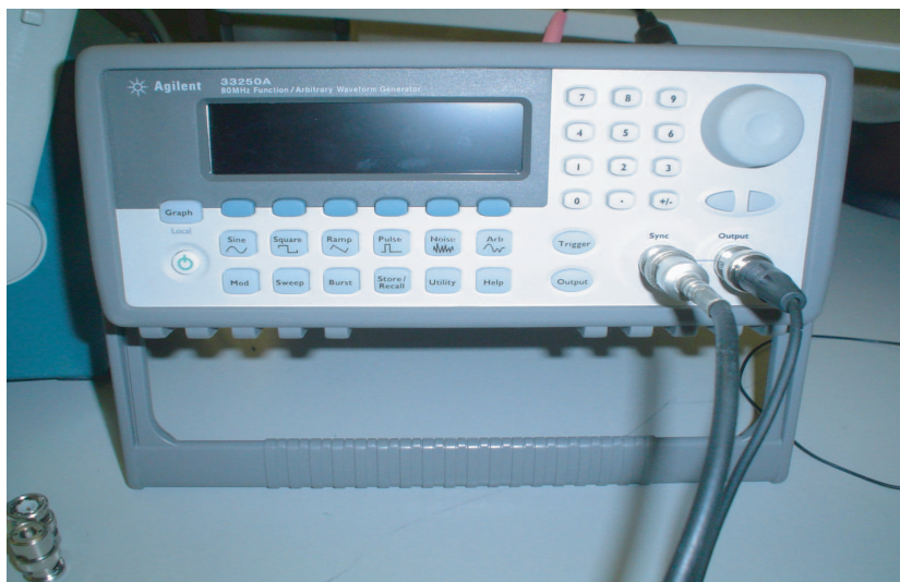
Figura 4.13: Gerador de Ondas Agilent 33250A.
