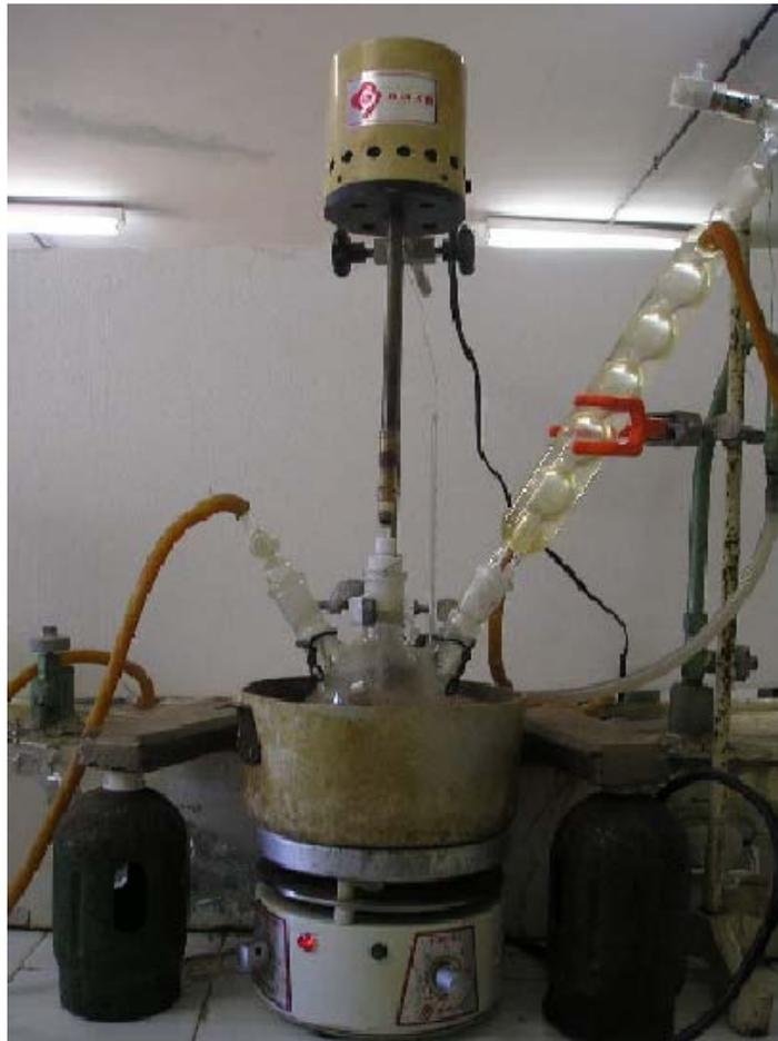
Figura 2.1 Aparato utilizado nas reações de modificação da vermiculita
