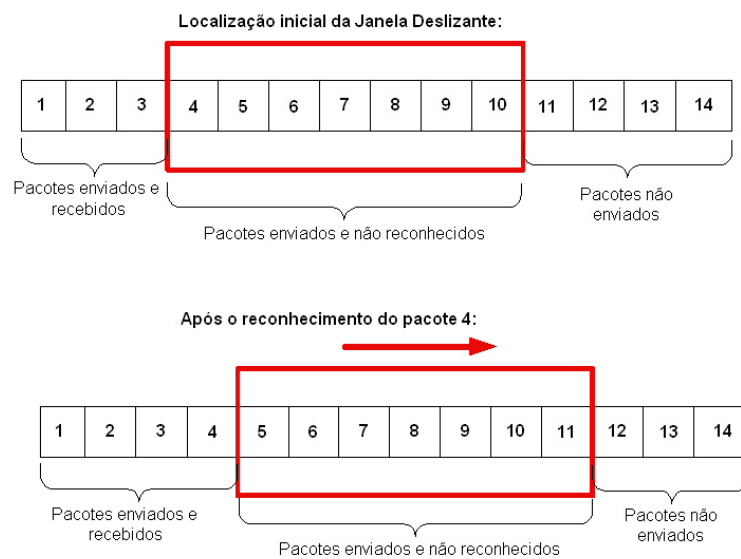
FIG. 2.8: Operação com a Janela Deslizante.
