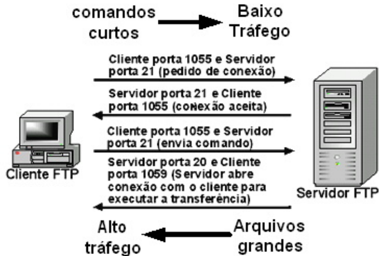
FIG. 2.3: Princípio de funcionamento do protocolo FTP.
