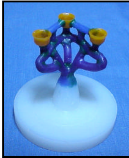
FIGURA 4.6 – Infra-estruturas, em cera, fixadas à base formadora de cadinho.
