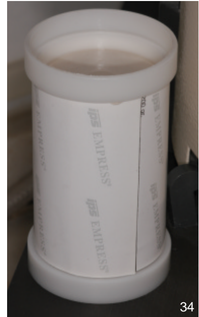
Figura 32 – Discos montados no anel de injeção do sistema IPS-Express
