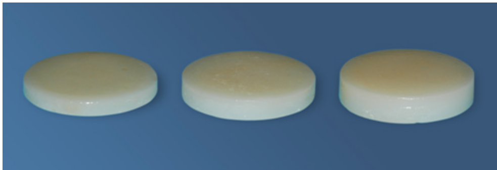
Figura 39 – Discos de cerâmica IPS-Empress nas espessuras 1,5mm (C1); 2,0mm (C2) e 2,5mm (C3)
