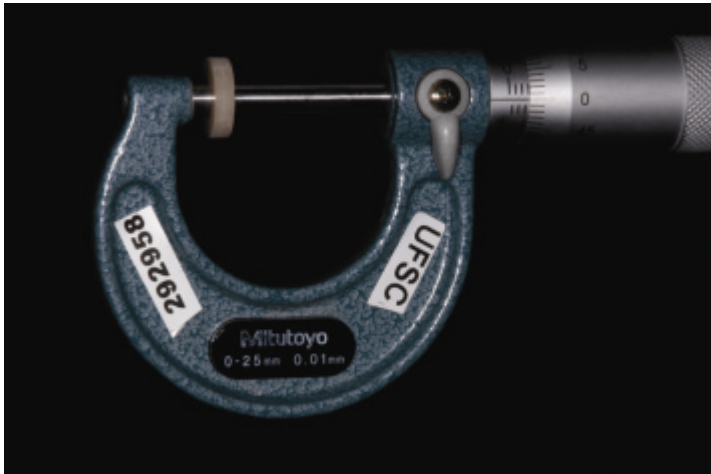
Figura 20 – Medição do disco com um micrômetro
