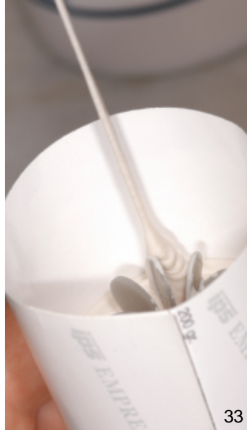
Figura 32 – Discos montados no anel de injeção do sistema IPS-Express
