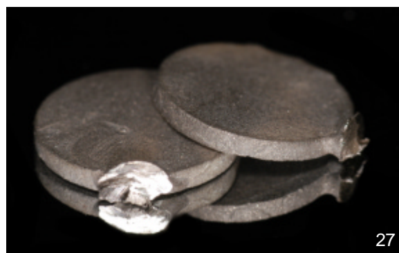
Figura 27 – Discos obtidos após o corte
