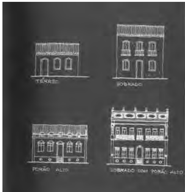
Fig.20– TIPOLOGIAS RESIDENCIAIS DO SÉCULO XIX. Observamos quatro tipologias mais frequentes das residências dos centros urbanos no Brasil do séc. XIX. A casa térrea e o sobrado remontam ao período colonial, e a casa de porão alto e o sobrado com porão alto são tipologias que irão surgir a partir de meados deste mesmo século. (Crédito da ilustração: cópia do livro: REIS FILHO, Nestor Goulart. Quadro da Arquitetura no Brasil . São Paulo, Editora Perspectiva, 2000).
