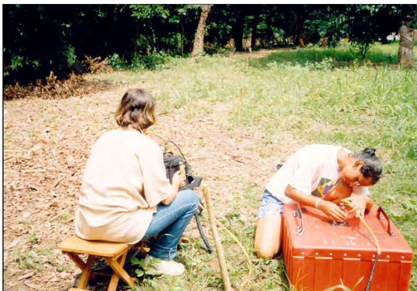
Figura 06. Atividade de prospecção geofísica do solo executada anteriormente à escavação arqueológica. No Engenho Uriboça, foi utilizado um aparelho de radar GPR (Ground Penetrating Radar).
